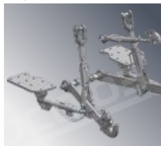
Задний гидравлический подъемник с быстроразъемными соединениями категории II и грузоподъемностью подъем 3500 кг.
