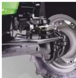
Компактный капот обеспечивает максимальный угол поворота 55°.
