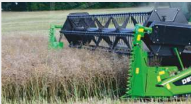
↑ Приспособление для уборки рапса для жаток с шириной захвата до 9 м.
