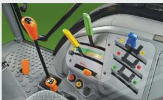
↑ Продуманное расположение элементов управления на правой консоли.
