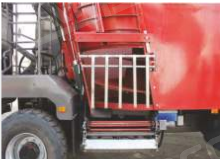
↑ Регулируемый разгрузочный транспортер со стороны водителя слева из стали 3CR12 с цепью C55
