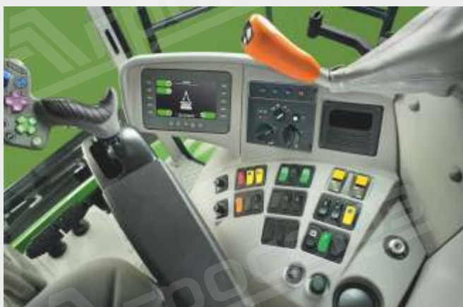
↑ Удобный доступ ко всем органам управления, многофункциональный джойстик COMMANDER Stick и 7" сенсорный дисплей.
