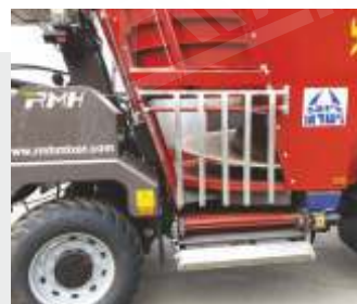
↑ Регулируемый выпуск транспортер с левой стороны водителя изготовлен из 3CR12 с C55 цепь.
