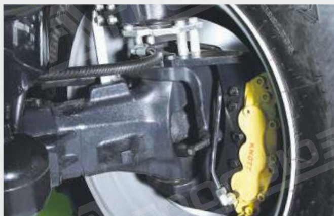
↑ 60 км/ч и максимальная безопасность благодаря сухим дисковым тормозам с системой ABS.
