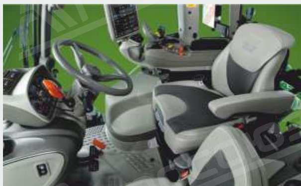
↑ Для повышения комфорта оператора сиденье может разворачиваться на угол до 20° (опция).
