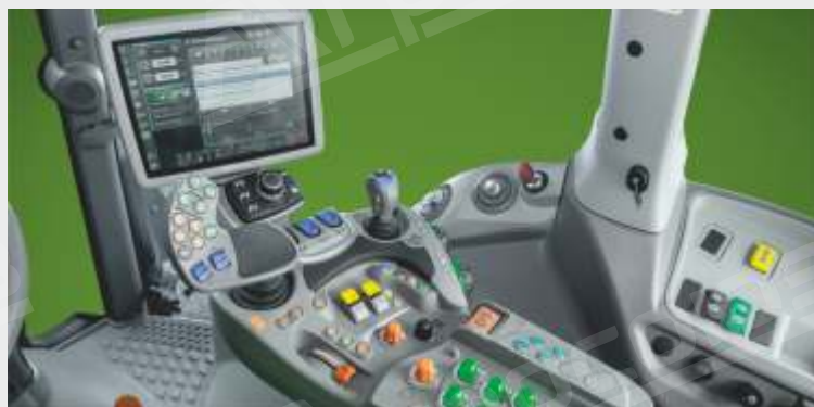
↑ Управление всеми основными функциями трактора с помощью многофункционального подлокотника с джойстиком.
